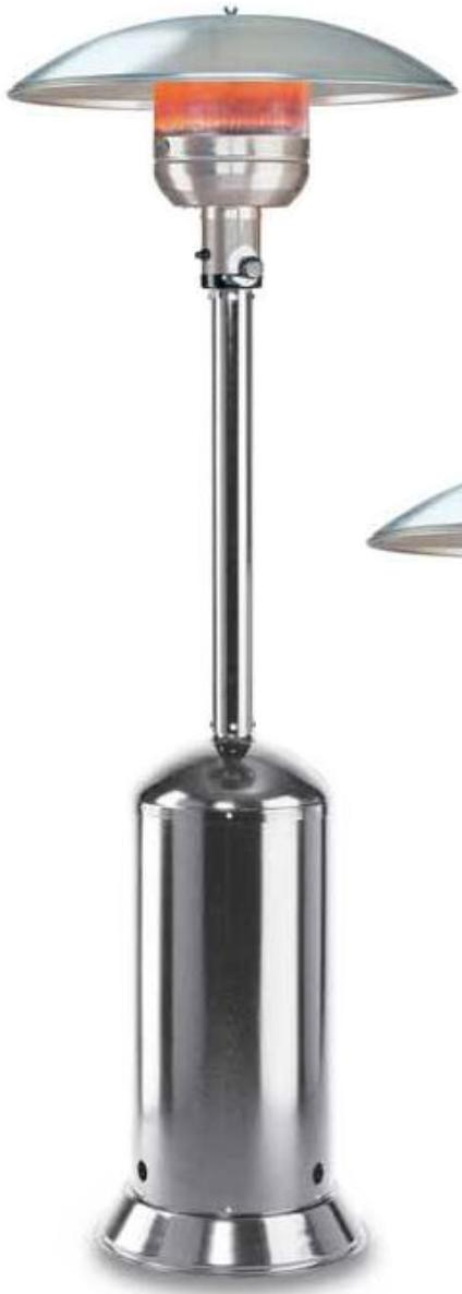
● Riscaldatore a raggi infrarossi dal design esclusivo. Tubo raccordato automaticamente. Potenza 12 kW. Consumo medio 0,7 kg/h. Superficie irraggiata 20/25 m<sup>2</sup>. Peso 35 kg. Bruciatore professionale in acciaio inox a volantino regolabile con MIN-MAX. (MIN-MAX-STAND-BY per modello 654102830A). Struttura in acciaio inox. Accensione piezoelettrica.
